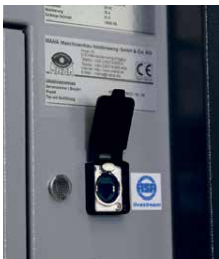
Beispiel asanetwork Livestream Schnittstelle an MAHA Bremsenprüfstand
